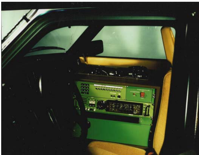
TLF-UTR K-BANA installerad i bil. Foto FFV.
