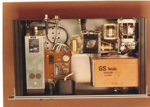
Autonom radio som redundans för det ordinarie radiosystemet. Foto FFV.
