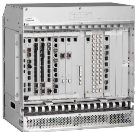
Figur 15: Exempel på WDM-utrustning i FTN (Foto: Transmode)
