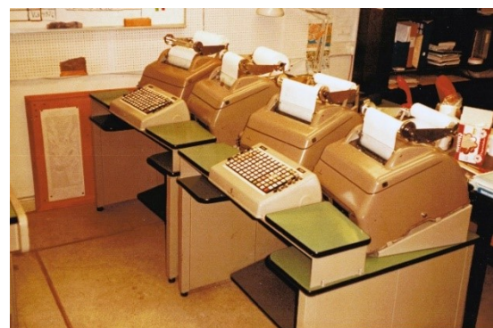
Expeditionsplats halvautomatisk fjärrskriftcentral Typ ES 2 Tillverkare: Philips i Holland
