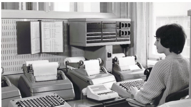
Expeditionsplats halvautomatisk fjärrskriftcentral Typ ES 2 Tillverkare: Philips i Holland
