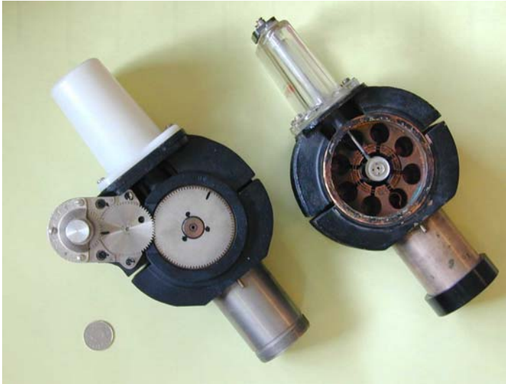
Bild 2. Magnetroner för PS-41/T. T.v. en mekaniskt avstämbar, t.h. en uppskuren magnetron. (Myntet är 25 mm i diameter)
