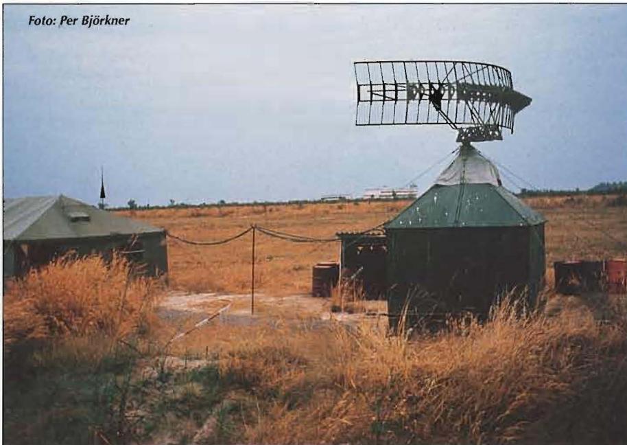
Svensk radarstation, PS 41, vid Kamina-basen. En ovärderlig utrustning för svenskarnas luftoperationer.
