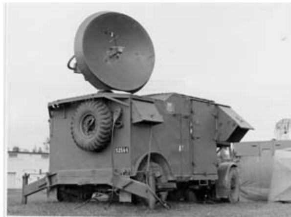
Eldledningsradarn PE-07 med roterande matare för vinkelmätning (conical scan).
