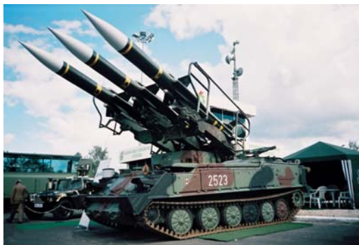
Bild 2:12. Lavettfordon till SA-6. Räckvidd 30 km, höjdtäckning 18 km, minsta skjutavstånd 4 km.
