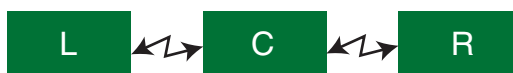
Bild 4:18. Inhämtningsenheten C tar emot bredbandig information från sidoenheterna L och R samt bildar de två aktuella tidsdiffrenserna. Typiska avstånd mellan central och sidoenheter i ett markbaserat luftbevakningssystem är 15 km.
