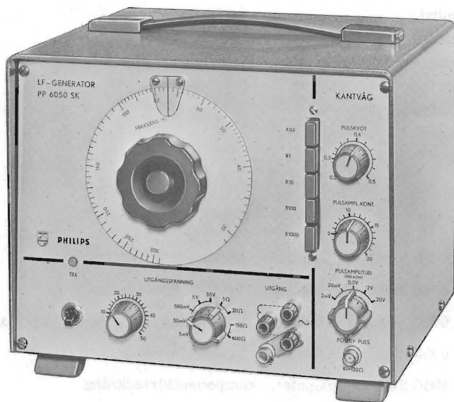
Bild 2. Universalgenerator PP 6050 SK
