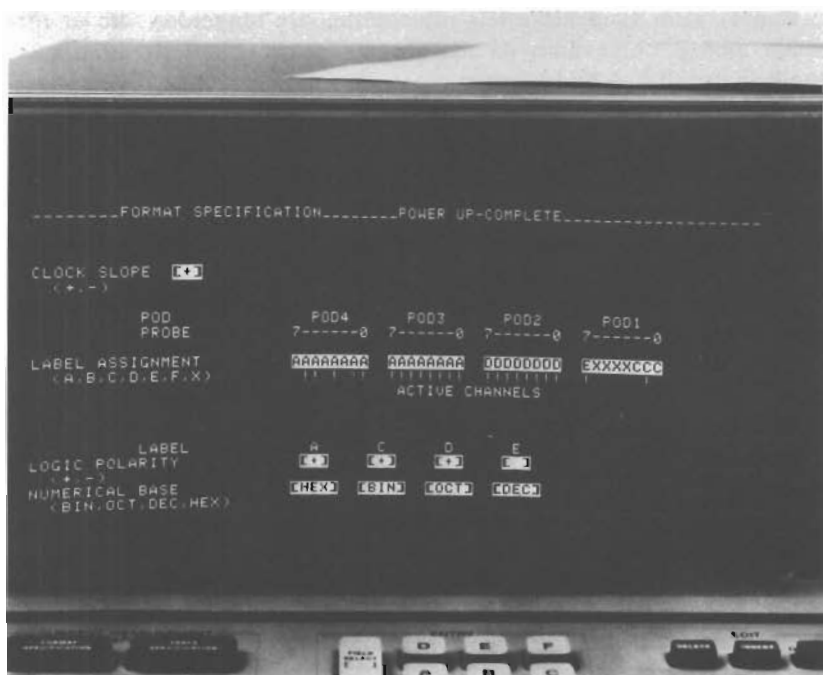
Bild 40. HP-1610A logik-analysator utnyttjar Meny-teknik. Formatering av de 32 kanalerna.
