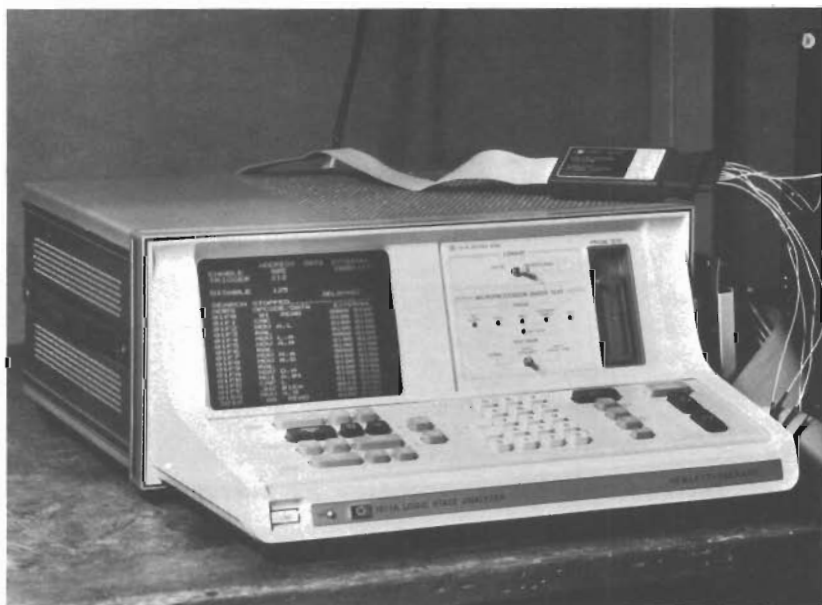
Bild 46. HP-1611A Logikanalysator, listning av ett program för Intel 8080.
