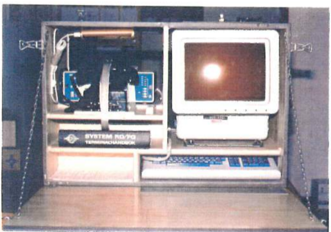
BÄRBAR UTRUSTNING ALFASCOP 35, telefon och telefon- modem för uppringning till DELTA, i låda för utlåning. Vikt cirka 40 kilo.
