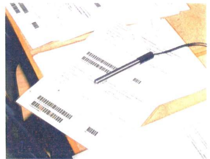
STRECKKODSPENNA för avläsning av Utlämningsordersedel som används vid RESMAT
