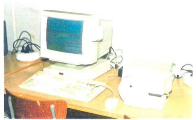
STRECKKODSUTRUSTNING PC 33 MHz processor, 40 Mb hårdisk med strekkodsskrivare
