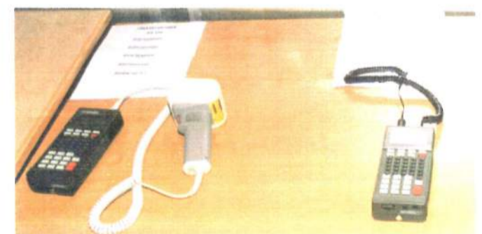
HANDDATORER MED LÄS-UTRUSTNING till vänster med handscanner och till höger med penna
