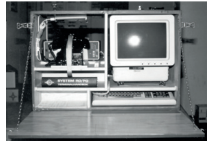
Alfascop 35 med telefon och telefonmodem för uppringning till DELTA. Denna bärbara utrustning för utlåning vägde cirka 40 kg.
