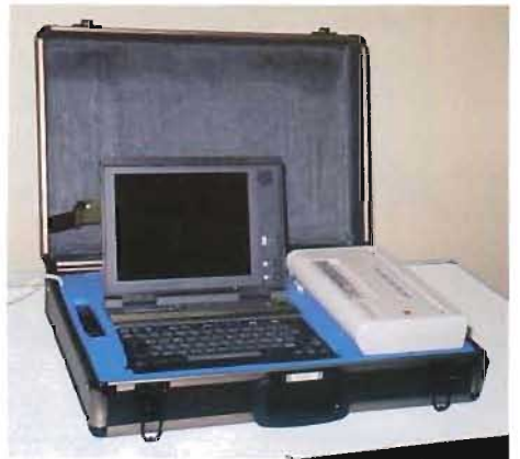
Bärbar DELTA-terminal. Modem för anslutning till telelinje finns inbyggt i datorn. Motsvarande utrustning finns med CD-läsare i stället för skrivare.
