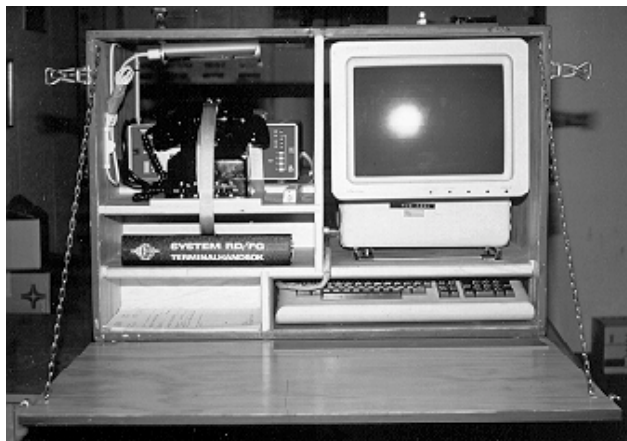
Alfascop-35 monterad i en "bärbar" utrustning för utlåning. Telefonmodem för att ringa upp DELTA, telefon och handbok fanns med i lådan.
