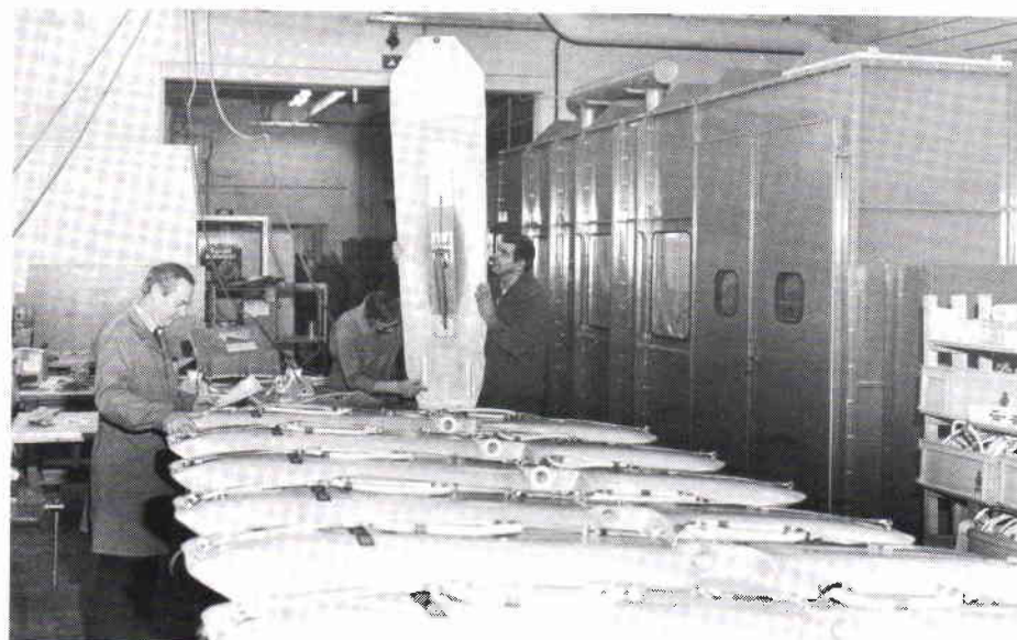
Slutkontroll av skidorna vid FFV Underhåll i Malmslätt. Skidan som hålls upp i bakgrunden är en nosskida.
