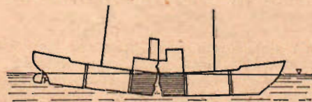
Fig. 7. Skadorna på fartygets mittparti äro så stora, att det brytes mitt itu, varefter vardera delen sjunker, det skadade partiet först med sina tunga maskindelar.
