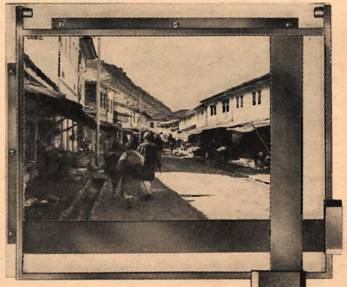
Fig. 10: Pappershållare (eller avmaskningsram). Linjalerna håller papperet plant och lämnar en rätvinklig ca 5 mm vit kant runt förstoringen.
