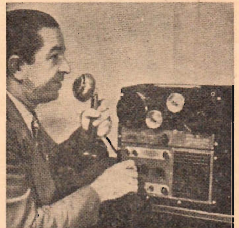
Den nya inspelningsapparaten i arbete. De som talar in texten kan själva sköta apparaten tack vare utstyrningsindikatorn.
