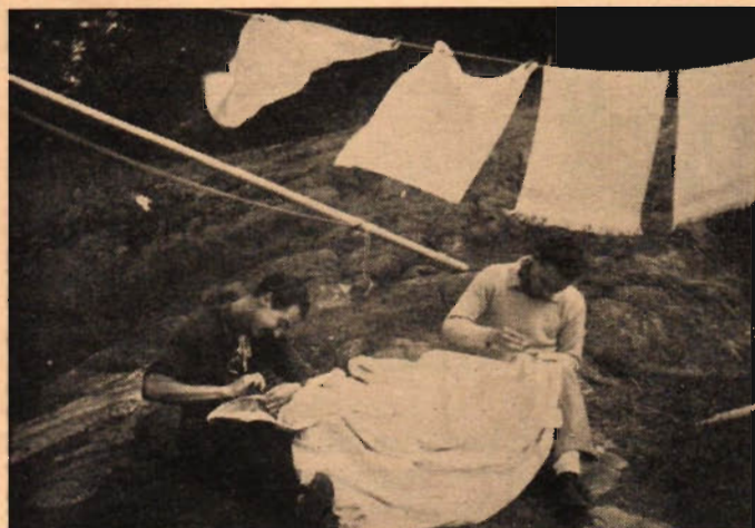
Seglen syddes till av ett gammalt skridskosegel och en dito foc. Denna ligger i toppen och det hela avklaras i flygande fling med vanliga stoppnålar. Båtbyggaren själv synes t. v. och han får hjälp av Kurt Johannesson.
