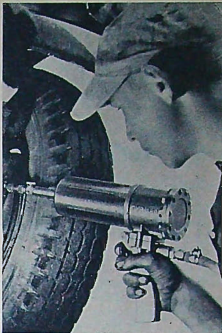
Rundsmörjning med Ljungmans sprutpistol.
