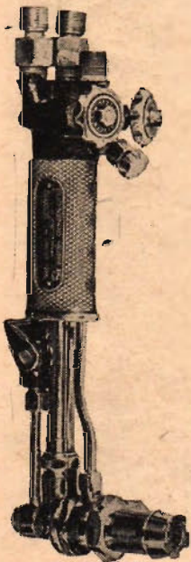
Fig. 1. Skärmunstycket — den moderne dykarens kniv med vilken han skär genom fartygssidor och stålballkar.
