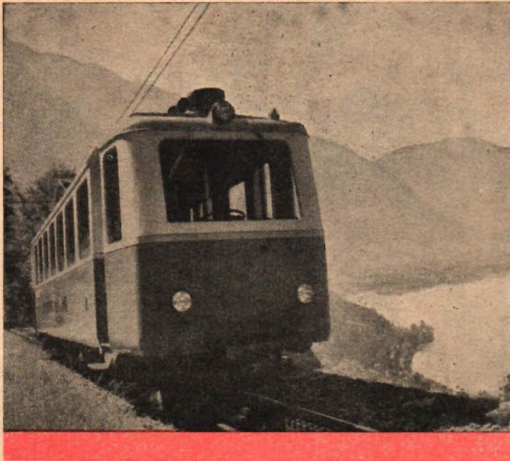
Med 800 VOLT LIKSTRÖM går denna lätta motorvagn från Montreaux-Glion-Rochers de Naye-banan. 80 resande får plats, motorstyrkan är 210 hk och en särskild bromsanordning å la spårhjul förhindrar vagnen att rutscha nerför backarna vid strömväbrott.
