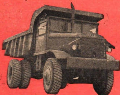
På vinjettbilden. Harsprånget i sommarskrud — snart ett minne blott. Därunder det vackra egna-nemområdet. — T. v. sprängstenen från tunnlar-na fraktes med specialbyggda 13-tonns lastbilar.
