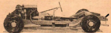
Ovan ett av utställningens största slagnummer — den 3,5-liters Jaguar, som påstås god för omkring 200 km/tim. — och nedan framgår hur Healey genom en skarp nedsvängning av ramen kommit fram till mycket låg tyngdpunkt.
