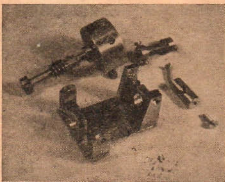
Snäckskruvaxeln är lagrad i två stycken SKF enradiga spärkullager E13 för 3 mm axel. T. h. om balanshjulet syns den böjliga axeln.
