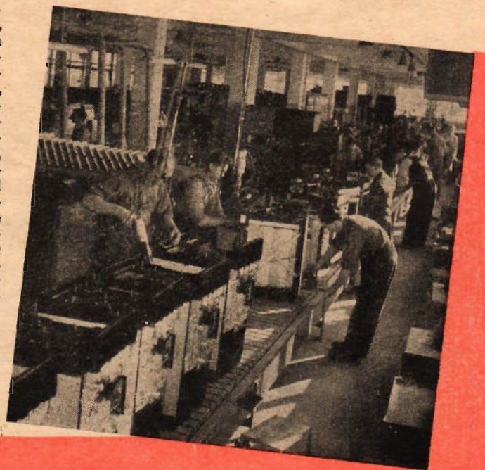
Montering av elspisar på löpande band i Elektro-Helios anläggning i Hammarby industriområde.
