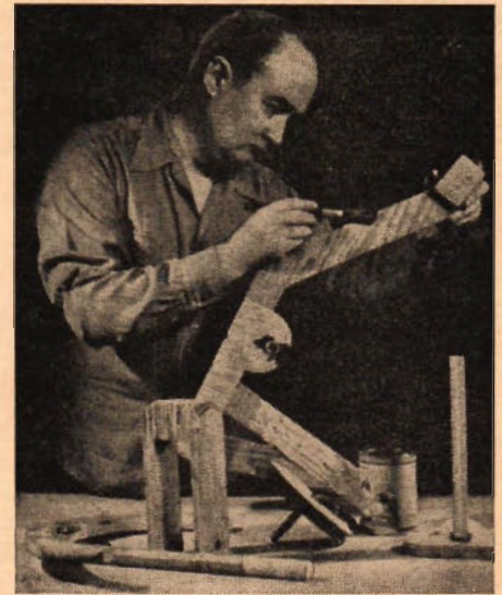
När ramdetaljerna hoplimmats ska de strykas med ett lager schellack eller fernissa.
