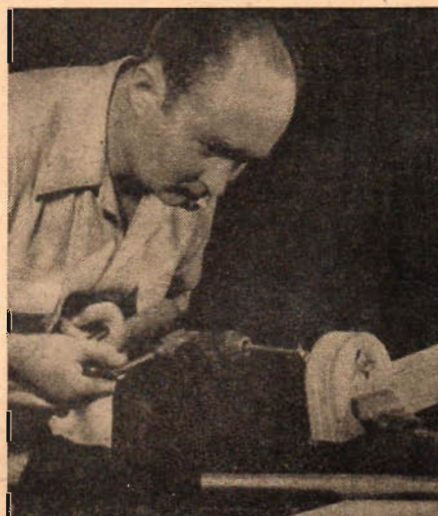
När vevpartiet borraras så läspåns det lämpligast i ett skruvstycke, de olika detaljerna borraras samtidigt.
