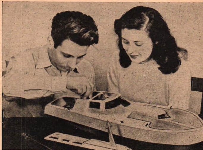
Ovan justeras motorn slutgiltigt in i det färdigbyggda skrovet. Kabintaket är lätt borttagbart.
