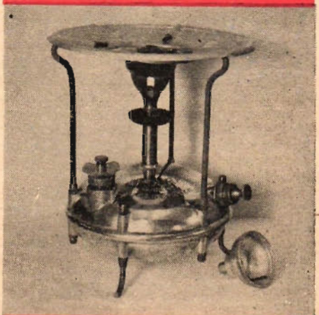
Nedan: "Endura"-köket, J. V. Svenssons sista konstruktion. Behållaren är pressad av aluminiumplåt och dessa två halvor är hopskruvade. Apparaten visade sig ej användbar, varför endast ett litet antal exemplar tillverkades.
