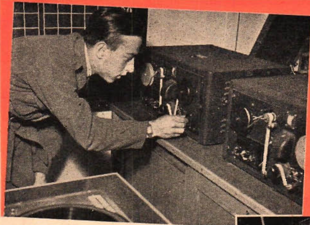
Dessa båda amerikanska fotocelltransmitter används för sändning av telegraf-text under utbildning i mottagning av telegram. I telegrafisalen finns plats för två lärare och trettio elever. Varje elev har också en sändarnyckel i sin pulpet. Radiostationen nedan sköts av två män. Den sänder på ultrakort våglängd, är frekvensmodulerad med 0,4 W antenneffekt. Ger god förbindelse på en mil.
