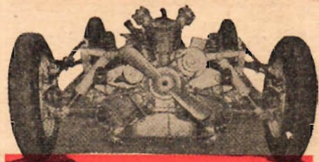
Trecylindrig, luftkyld 800 cc motor av flygmotortyp med enslängig enkel motoraxel återfinns i den framhjulsdrevna Italienska Opes.
