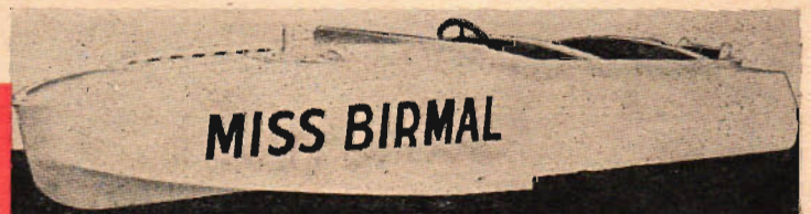
Ovan en typisk "dubbelkilbåt" från mitten av 1920-talet. Längd 12,2 m. Fart ca 30 knop. T. v. en nitad lättmetallbåt under byggnad. Nedan den första av den brittiska lättmetallfirman Birma-bright 1930 byggda lättmetallbåten. Den utfördes i gjutna sektioner som bultades samman.
