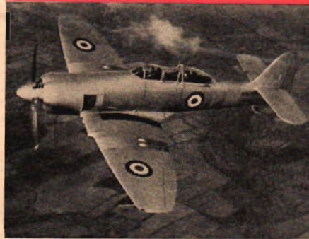
Ovan: Boulton Paul Balliol med sin 1 200 hk Merlin-motor har ungefär samma prestanda som mellankrigsårens attackplan. Nedan Royal Navys övningsplan Hawker Sea Fury T.Mk 20. Motorn är en Bristol Centaurus 18. Två 20 mm automatkanoner är inbyggda i vingarna.
