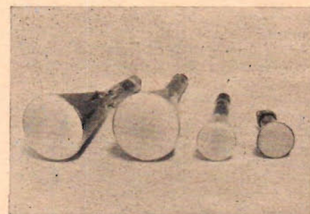
Fig. 2. Olika typer av katodstrålerör. Från vänster till höger: a) 5" rör av typ 5J1 för höga frekvenser med direkt anslutning på avlänkingsplattorna (Telekon AB). b) Normalt 5" rör av typ 5BP1, 5BP4 och 5GP1 (AB Bo Palmblad). c) 3" rör av typ 3AP1 (A, B och C av amer. tillv.), d) 2 3/4" (70 mm) rör av europeisk tillv. typ DG7-5 (Sv. AB Philip).
