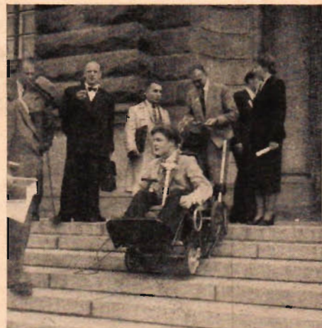
Ovan rullstolen som går i trappor. Genom en bandanordning kan en vanlig rullstol sänkas så att den tar sig uppför och nedför en trappa. T. v. en anordning för att dricka ur glas, när händerna inte kan användas till lyftande rörelse.
