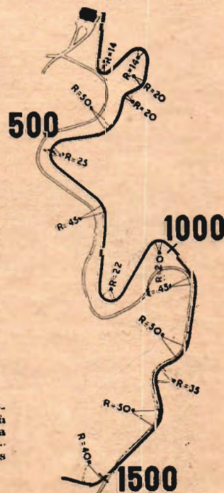
Bobsleighbanan på Forgneseetrasens östsidan har en fallhöjd på 13-12 meter på det 1 500 meter långa spåret. Oran en bob i olympiaspåret, t. h. en karta över bobsleighbanans sträckning.
