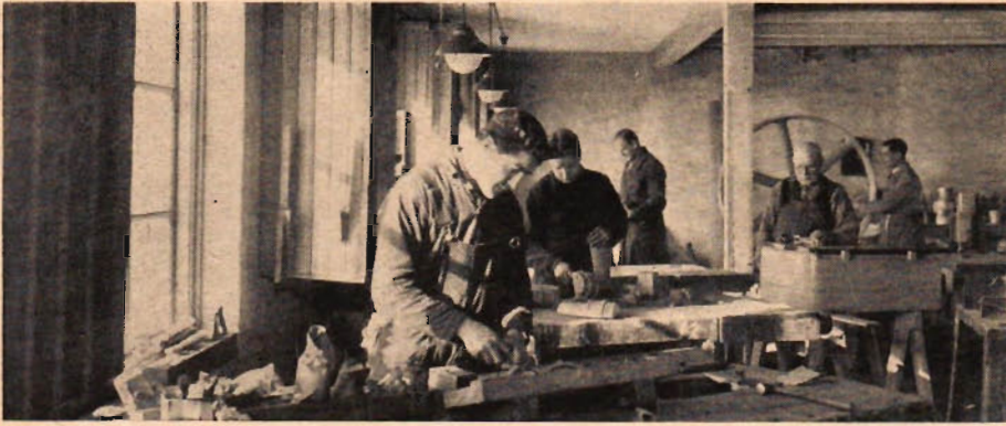
En bild från Avos modellverkstad, där alla gjutmodeller och formar utförs i trä. Den är relativt stor, enär firman arbetat med många specialtillverkningar i små serier.
