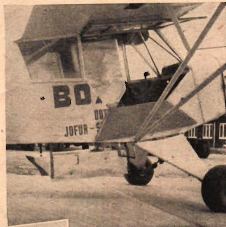
Apparaten för spridning av puder enligt venturirörprincipen monterad i en Cub.
