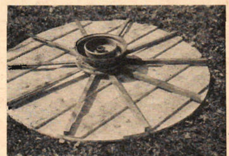
Nedan: Hjulet med de radiellt fastsatta vinkeljärnen demonteras medan det fastbultas vid plattformen.
