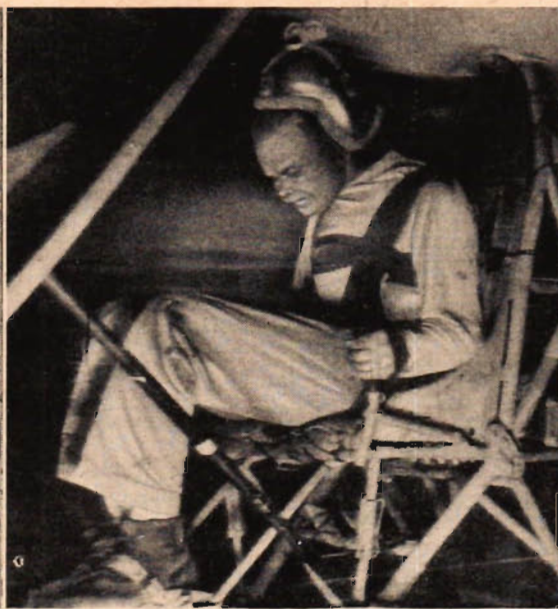
På bromssläden visar det sig att människan mycket väl kan utstå en bromschock motsvarande 4 ton (bilden t. v.) under förutsättning att hon är utrustad med ordentliga säkerhetsanordningar, exempelvis säkerhetssele och tandskydd, som ovan plockas ut efter genomgången prov.
