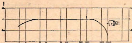
Fig. 2. Frekvenskaraktistik utan motkoppling för slutstegets utgångstransformator.
