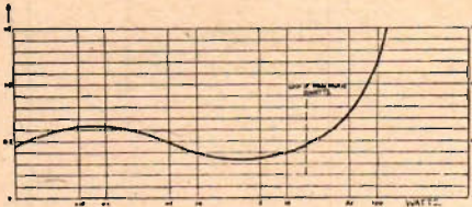
Fig. 3. Distortionskurva till fig. 2.
