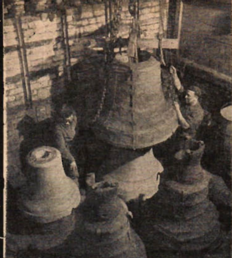
Gjutformarnas mäktiga ytterhöljen firas ned över klockornas innerformar. Bakom dem danar den smälta metallen i ugnen. På formarna längst fram har man plockat på gjutsumparna, som fångar upp metallen sedan formarna grävts ned i gjutgropen.
