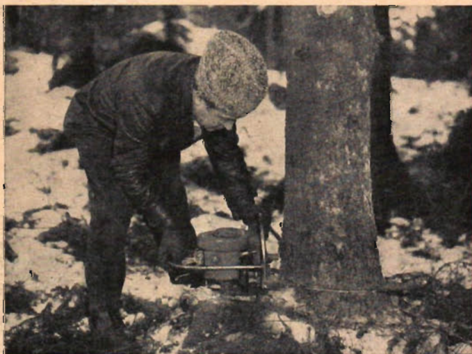
Motorsågen (t. v.) och barkningsmaskinen (t. h.) förvandlar helt huggarens arbete. Motorsågen gör visserligen inte ännu hans arbete lättare — snarare tvärtom — men den ökar hans produktivitet högst väsentligt. Barkningsmaskinen däremot befriar honom från det absolut tyngsta arbetet, som dessutom under dåliga väderleksförhållanden drog ned hans genomsnittsinkomst betydligt. Här har man satt in barkningsmaskinen som en länk i transportkedjan.
