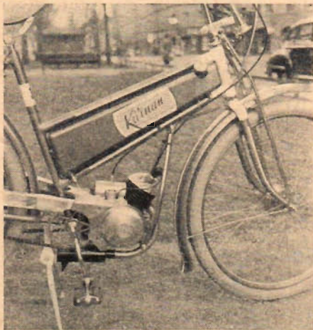
Vimpeln, tillverkad i Varberg för Eols och Hakons räkning, har dubbelröraram och teleskopgaffel.
