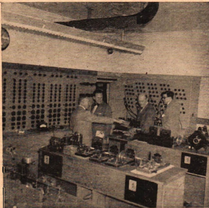
I teletekniska laboratoriet undersöka även brandskadade radioapparater som misstänkta ha förorsakat eldsvåda. Här granskas 3 exemplar som inlämnats av olika polismyndigheter.
