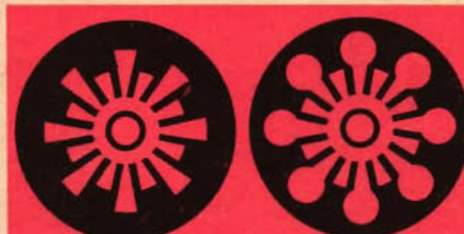
Fig. 4. I "rising sun"-magnetronen är de intill varandra liggande resonatorerna avstämde till olika resonansfrekvenser.
