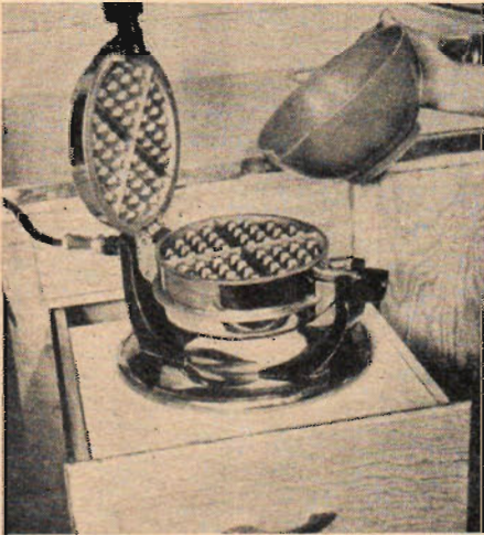
Den andra av de övre lådorna kan vid behov förvandlas till hylla för det elektriska väffeljärnet genom att lådans sidor förses med två lister mot vilka en plywoodskiva läggs.
