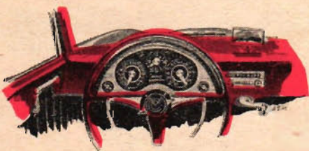
Instrumenten är väl samlade innanför rattens övre halva.
