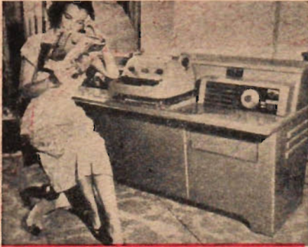
Denna bild av framtidens skrivmaskinsflikta är förvisso arrangerad, men maskinen hon sitter framför finns redan. Det är en Auto-Typist, som kan skriva ut hela stycken genom anslag på en enda tangent.
