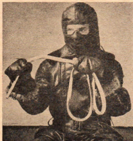
Fluorplast används för tillverkning av böjliga rör, som ska motstå stark värme. Bl. a. används de för ledningsisolering i stratosfärflygplan.
