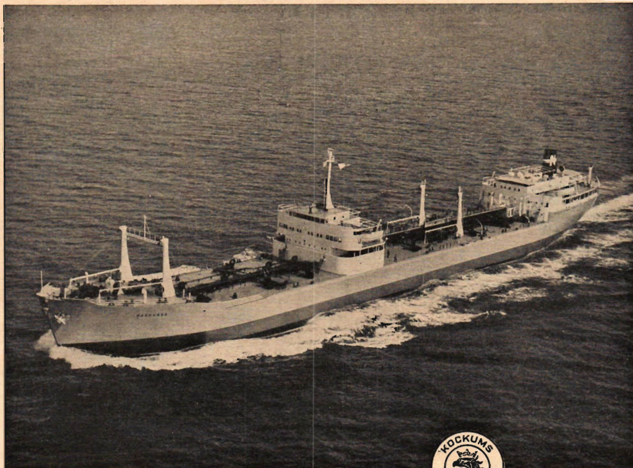
T. T. Saxonska levererades liksom systerfartyget T. T. Saxonsky 1953 till Oriental Tanker Corp. S. A., Panama. Dödvikt 20 200 ton. Fart 15 \frac{1}{4} knop.
