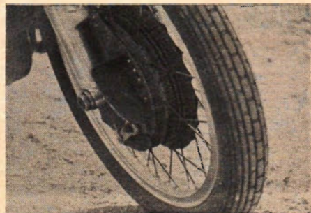
Nortons frambröms med forcerad ventilator-kylling.
