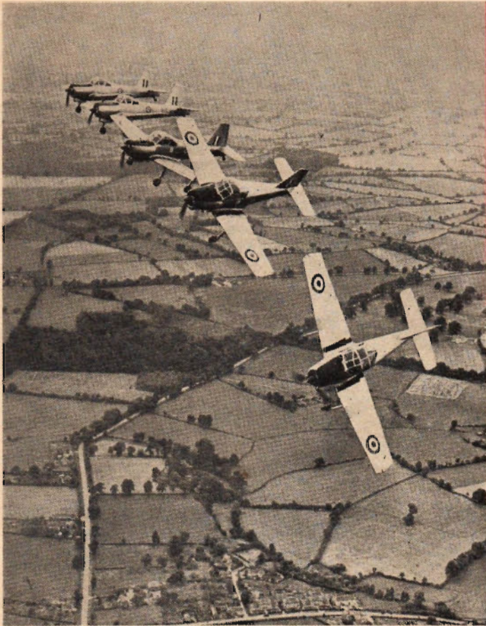
T. v. Percival Provost T. Mk. 1 är det brittiska flygets främsta skolflygplan för den egentliga flygutbildningen. Det drivs av en Leonides Mk. 126 nio-cylindrig motor med trebladig propeller. Ovan reaskolplanet Jet Provost som till det yttre är så lika propellerversionen att 60 procent av delarna i själva planet kan användas i bägge versionerna. Nedan A. V. Roe 707 C är ett skolflygplan avsett för utbildning av flygare till deltavängade plan. Nederst den modell som utställdes på Farborough av reaskolplanet Boulton Paul P. 134.
