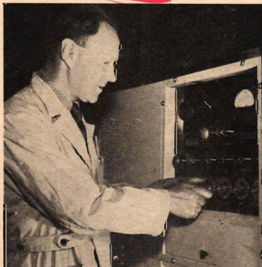
Det manuella arbetet med detaljerna som ska färgbehandlas består utestående av plockning på och av konvejern, som ovan visas av Hans Holm. Verkmästare Arne Åsbrink (t. v.) vid manöverpanden är full av beundran för sin nya maskin, som behandlar stativen mer än 12 gånger fortare än en sprutmålare. Såväl speckel som lack påläggs på detta sätt.
