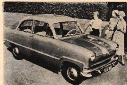
Nya 15 M är försedd med 55 hk 4-cyl. toppventilmotor.
